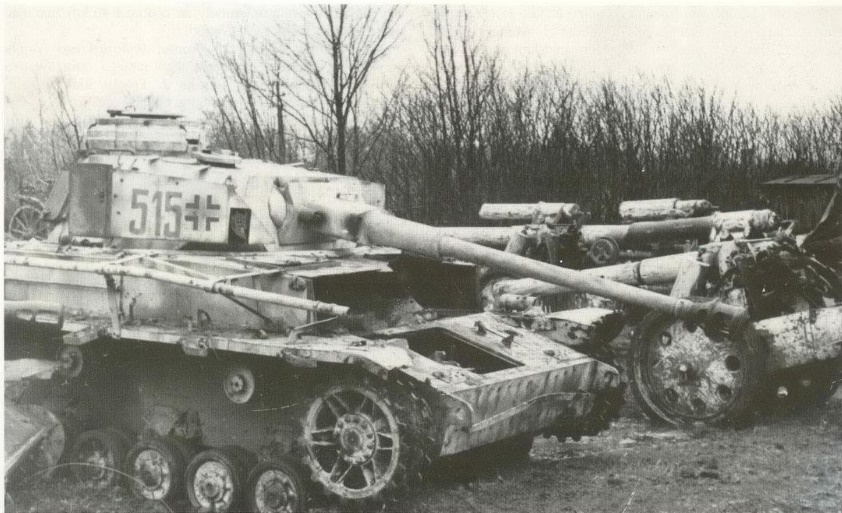
Czołg PzKpfw IV Ausf. J z 31. Pułku Pancernego 5. Dywizji Pancerniej, Prusy Wschodnie, marzec 1945 rok. Widoczne godło pułku namalowane na wieży. The PzKpfw IV Ausf. J tank from the 31st Panzer Regiment 5th Panzer Division, East Prussia, March 1945. Note regimental badge painted on the turret. [ASKM]
