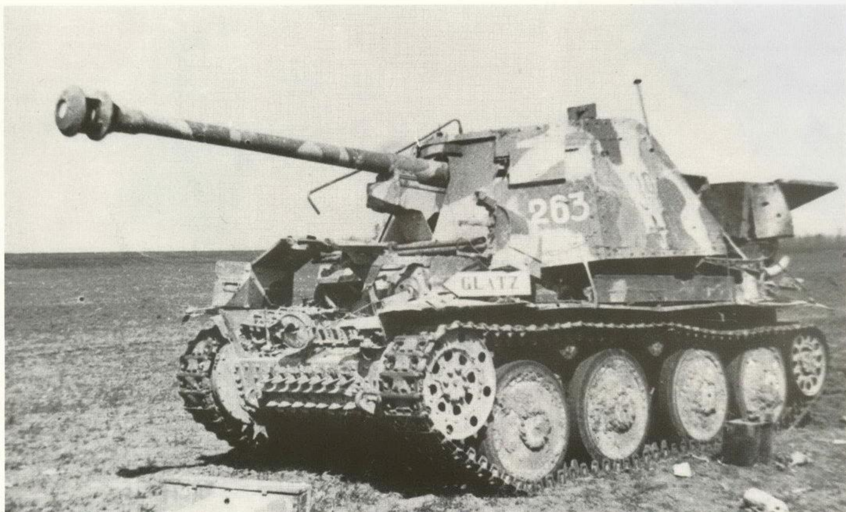
Działo samobieżne 7,5 cm Pak 40/2 Sf auf Fgst PzKpfw 38(t) Sd Kfz 138 Ausf. H „Marder” III z nieustalonej jednostki, Węgry, marzec 1945 roku. An 7.5 cm Pak 40/2 Sf auf Fgst PzKpfw 38(t) Sd Kfz 138 Ausf. H “Marder” III SP AT gun from unidentified unit, Hungary, March 1945. [ASKM]
