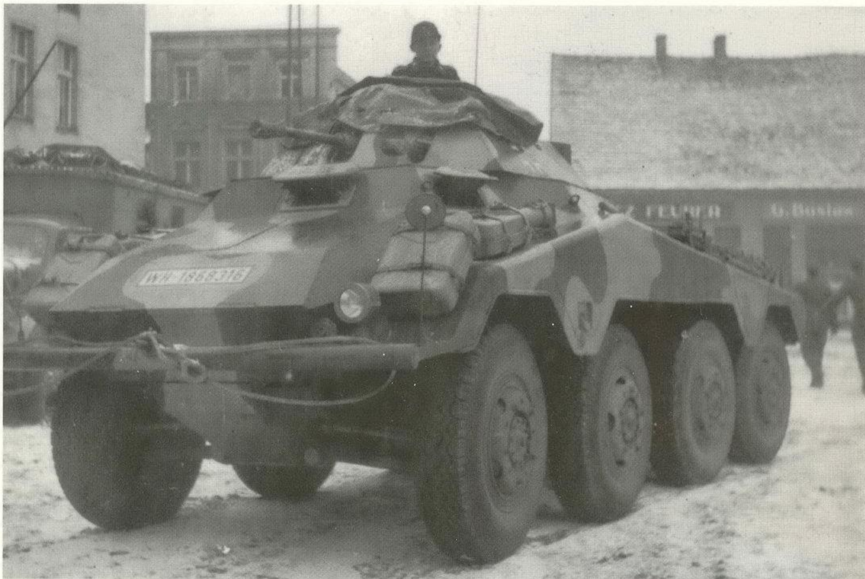
Samochód pancerny Sd Kfz 234/1 z 4. Dywizji Pancernej. Pojazd należał do ostatnich serii produkcyjnych w związku z czym posiadał tylko dwa, zamiast czterech, schowki narzędziowe z boku kadłuba. A Sd Kfz 234/1 heavy armoured car of the 4th Panzer Division. The vehicle belongs to the late production series, which can be recognized by two, instead of four, tool closets in each of the mudguards. [MWP]
