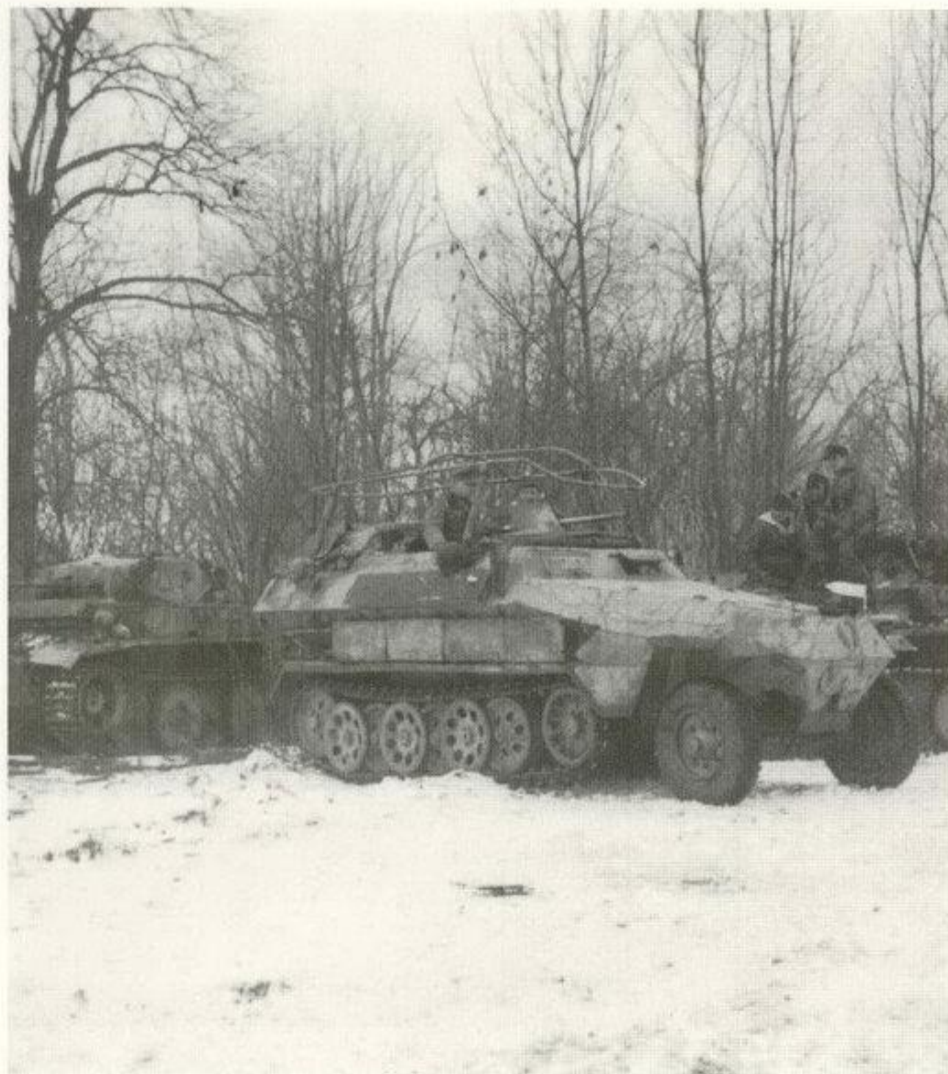
Trzy pojazdy pancerne 4. Dywizji Pancernej – dwa czołgi PzKpfw II Sd Kfz 123 „Luchs” i wóz dowodzenia SdKfz 251/6 Ausf. B, Kurlandia, grudzień 1944 roku. Three armoured vehicles of the 4th Panzer Division: two of them are PzKpfw II Sd Kfz 123 „Luchs” recce tanks and the other is a Sd Kfz 251/6 Ausf. B armoured command vehicle, Kurland, December, 1944. [MWP]
