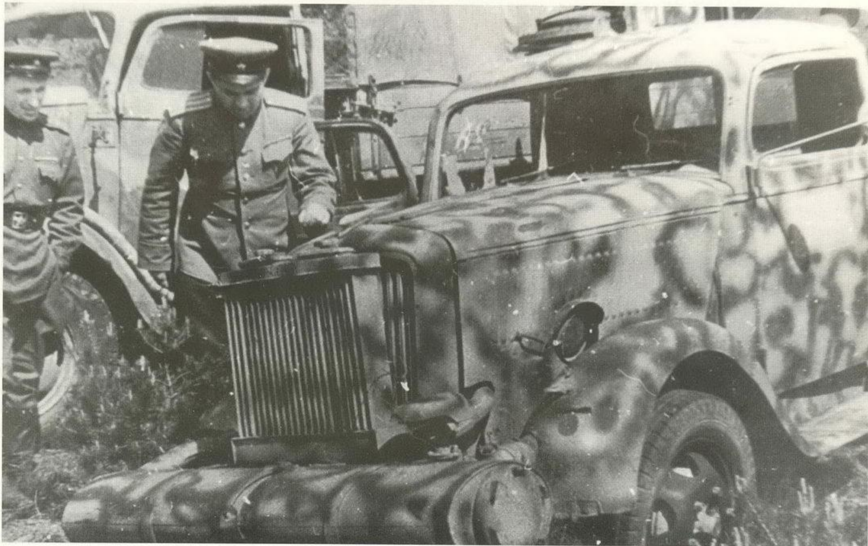
Zdobyty samochód ciężarowy Opel 1,5 ton Blitz wyposażony w generator gazowy typu Imbeth, Prusy Wschodnie, 1945 rok. A captured gas-powered Opel 1.5ton Blitz truck, East Prussia, 1945. Note vehicle was fitted with Imbeth gas installation. [ASKM]
